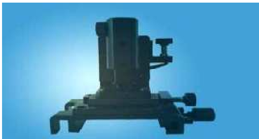
Obr.3.4.3. – Pojezd s držákem umožňující pohyb do dvou směrů – převzato z přílohy [5]
